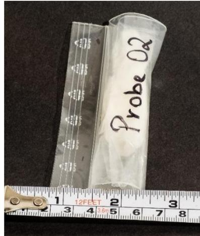
Abb.2b: Wischprobe zusammengerollt (ohne Lufteinschluss).
