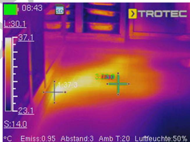
**Abb. 3: Thermografie in der Umgebung des Küchenblocks. Nach erfolgter Isotopenanalyse wurde gezielt nach Leitungsschäden gesucht. Die schadhafte Stelle zeigte sich als ausuferndes Wärmefeld (weiß bis orange) einer defekten Warmwasserleitung im Küchenboden (Foto L. Trommler, Strobl Service GmbH).**
