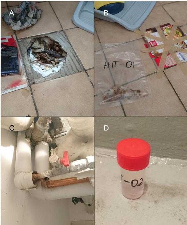
**Abb. 4:** A) Konstruktionsöffnung im Küchenboden einer Wohneinheit des Mehrfamilienhauses. Nässende Feuchte am Boden der Öffnung. B) Wischprobe aus Konstruktionsöffnung, luftdicht verpackt (Probe 01). C) Installationsschacht in Kellergang. Stetig tropfendes Wasser zu beobachten. D) Probe Flüssigwasser des Tropfwassers aus dem Installationsschacht (Probe 02) (Fotos S. Wiesmaier, Hydro-Detect).
