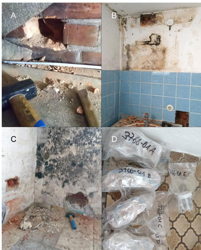
**Abb. 6:** A) Bauteilöffnung in einer Ziegelwand des Speichers (Probe 01). B) Bauteilöffnung im Badezimmer (Örtlichkeit des ursprünglichen Wasserschadens, Probe 02). C) Bauteilöffnungen im Keller (links Probe 03 Kellerinnenwand, rechts Probe 04 Kelleraußenwand). D) Probenfamilie: 4x Bruchstücke aus Bauteilöffnungen sowie 1x Flüssigwasser (Leitungswasser, Probe 05) (Fotos S. Wiesmaier, Hydro-Detect).
